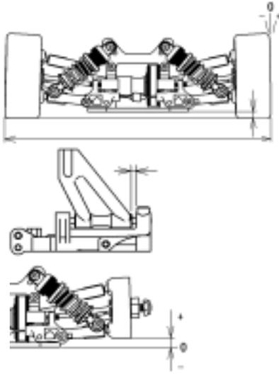
車幅 \_\_\_\_\_ **199** mm
